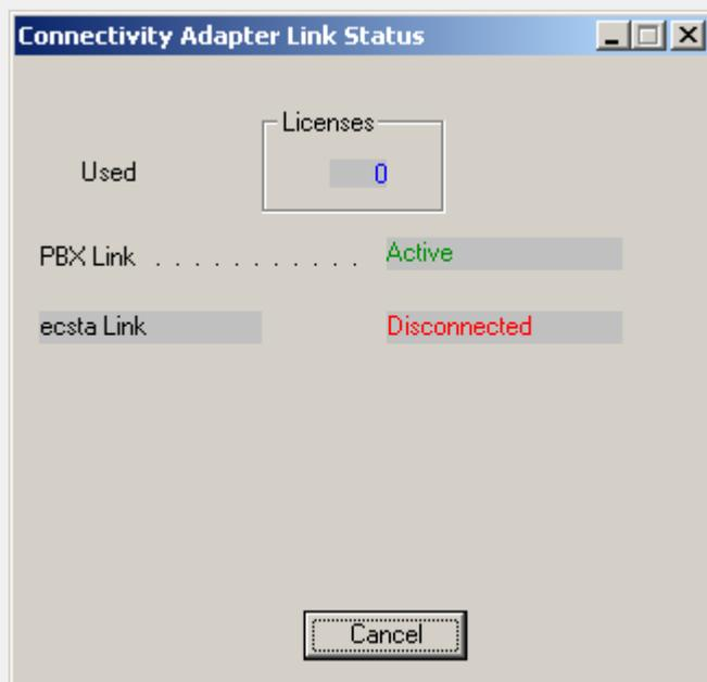
Installieren Sie nun den ECSTA. Unter CAP Login verwenden Sie die Option **OpenScape 4000 - Native Mode CA4000**. Unter Netzwerkverbindung verwenden Sie den Host auf dem der CA4000 installiert ist und den TCP Port (Default 1045), den Sie im CA4000 konfiguriert haben. Siehe auch Einstellungen Allgemein.
