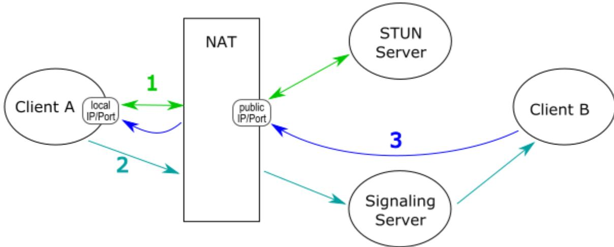
Abb. 3: Erfolgreiche Kommunikation unter Zuhilfenahme eines STUN-Servers.
