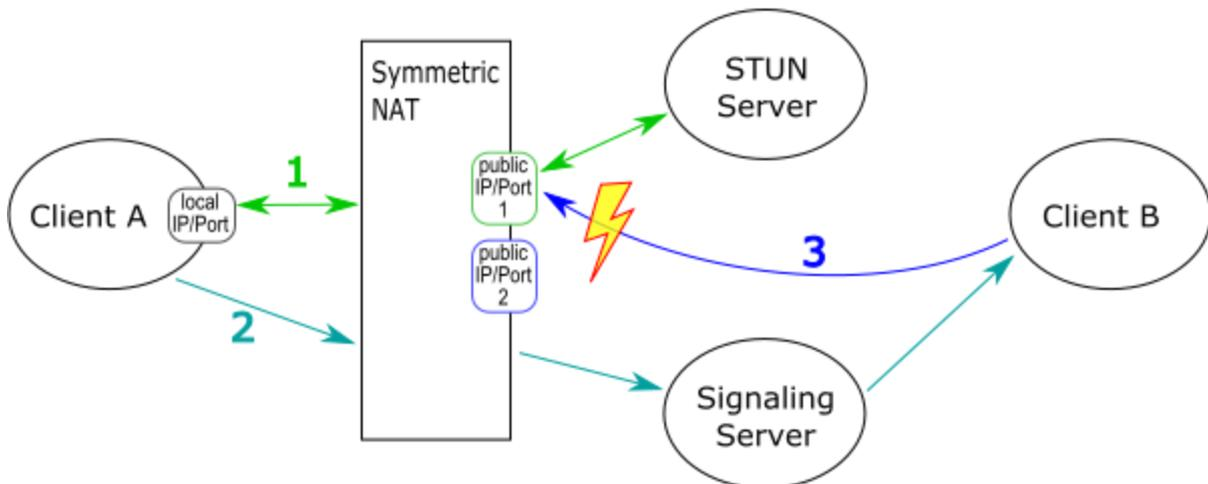
Abb. 4: Erfolgreicher Kommunikationsversuch über ein "Symmetric NAT".
