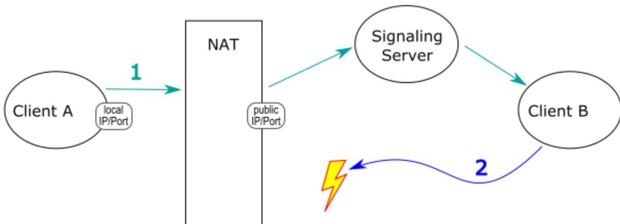
Abb. 2: Erfolgreicher Verbindungsaufbau über einen NAT-Router hinweg.
