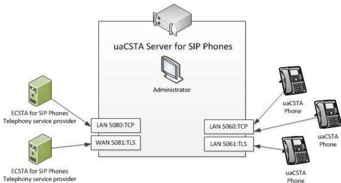
Der ECSTA for SIP Phones stellt als Telephony Service Provider (TSP) eine standardkonforme TAPI Schnittstelle bereit. Der Treiber wird in Verbindung mit TAPI nutzenden Applikationen eingesetzt (UCServer, ProCall, andere TAPI Applikationen).
